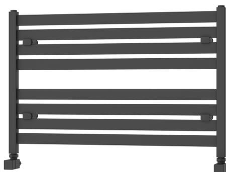
Termoarredo orizzontale piatto in acciaio. Collettori verticali rettangolari 40x30 mm con spessore 1,5 mm. Elementi orizzontali a tubi piatti 40x10 - spessore 1 mm. Pressione massima di esercizio: 8 bar. Fornitura standard: 4 fissaggi, 1 tappo cieco, 1 valvola a sfiato 1/2". Disponibile nelle versioni bianco o antracite. Fornito senza valvola termostatica e detentore.
