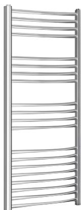
Termoarredo in acciaio. Spessore profili 1,2 mm. Elementi orizzontali a tubi tondi Diam. 22mm - spessore 0,90mm. Pressione massima di esercizio: 8 bar. Fornitura standard: 3 fissaggi, 1 valvola sfiato 1/2". Collettori verticali semiovali 40x30 mm.
